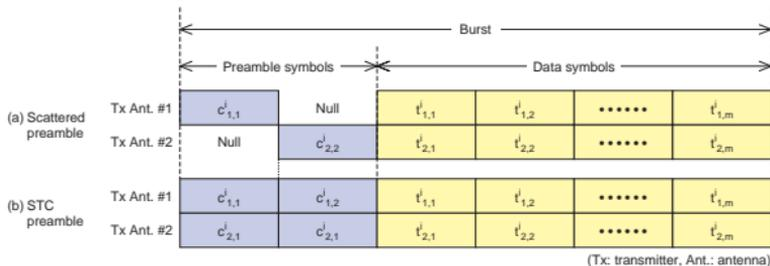
Fig. 3. Frame formats for  $i$ -th subcarrier.
